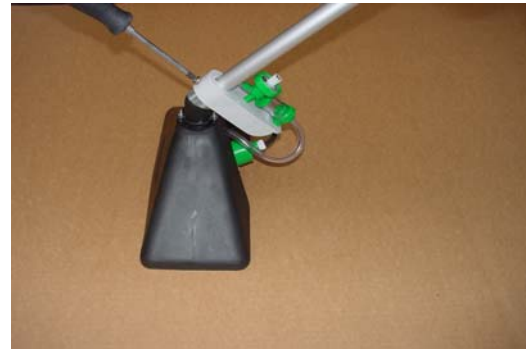
2. Durchflusskontrolle mit Spritzschirm und Spritzschirmträger verschrauben
