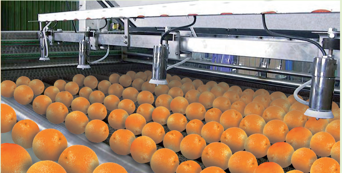
Das Feinsprühgerät MAFEX-Potato / MAFEX-Fruit kann mit bis zu vier speziell entwickelten Rotationsdüsen ausgestattet werden. Die Abbildung zeigt die Anwendungsmöglichkeit über einem Sortiertisch für Früchte
